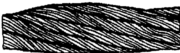
Рисунок 13. Местное увеличение диаметра каната.
