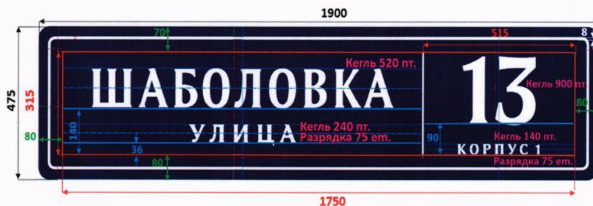
Оформление надписей на магистральном домовом указателе «комплект совмещенный, улица и номер дома» (ДУ-М-С), когда в номере дома менее 3 символов
