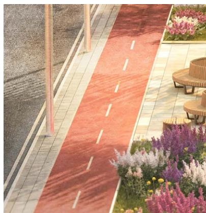
Цветной асфальт на прозрачном полимерном связующем
